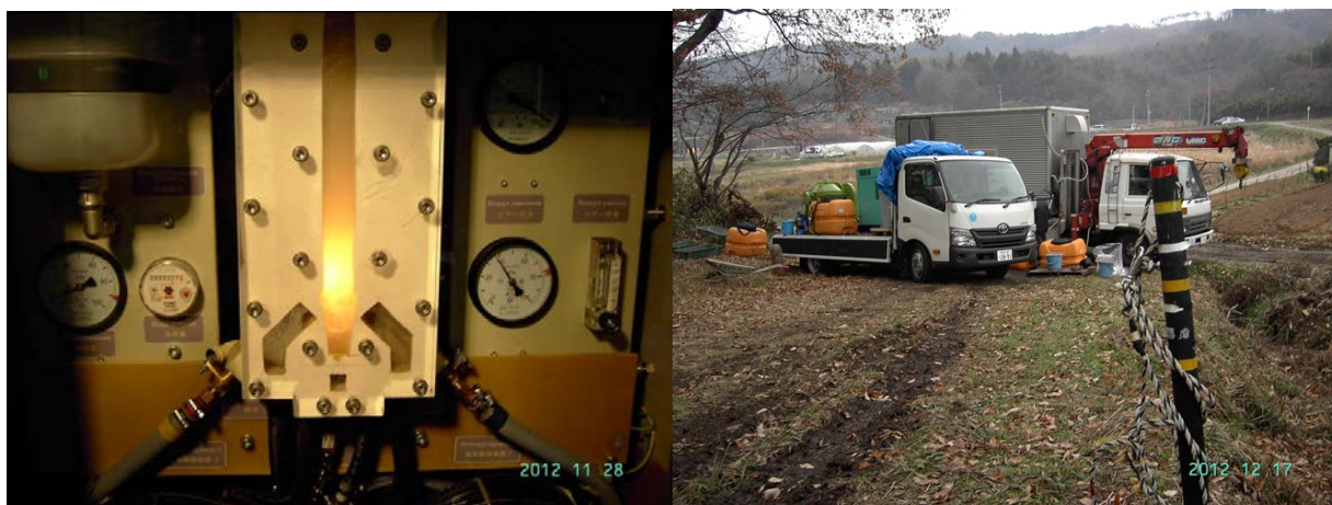
Рис. 5. Установа плазмохімічного очищення води та пересувна установка в префектурі Фукусіма
