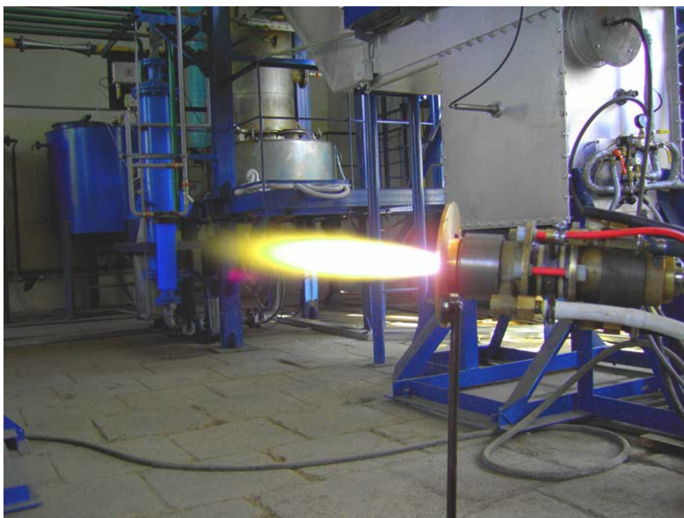
Рис.2. Паровий плазмотрон потужністю 150 кВт у складі пілотної установки для отримання синтез-газу з твердих органічних відходів
