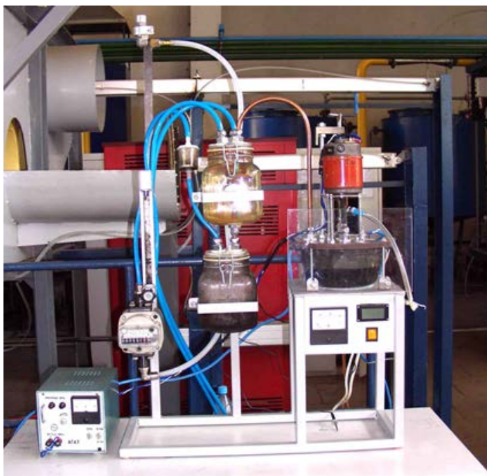
Рис.3. Установка для отримання синтез - газу з рідких органічних відходів
