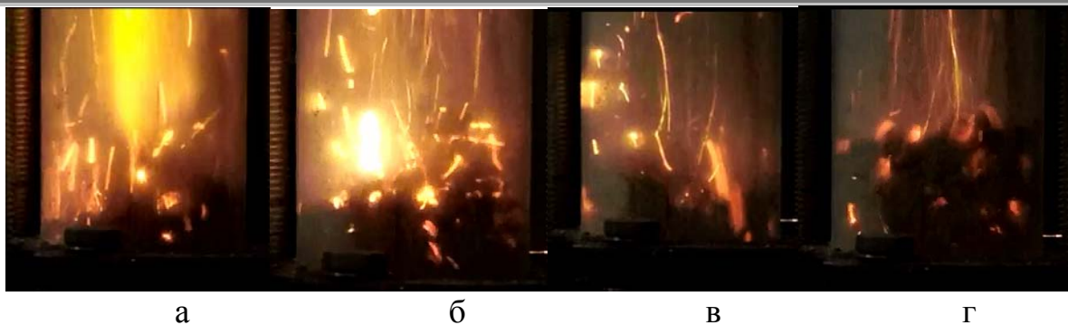
Рис. 3. Выделение летучих и горение частиц бурого угля с диаметром от 1-10 мм в кипящем слое: а - T=870 К; б - T=890 К; в - T=880 К; г - T=850 К
